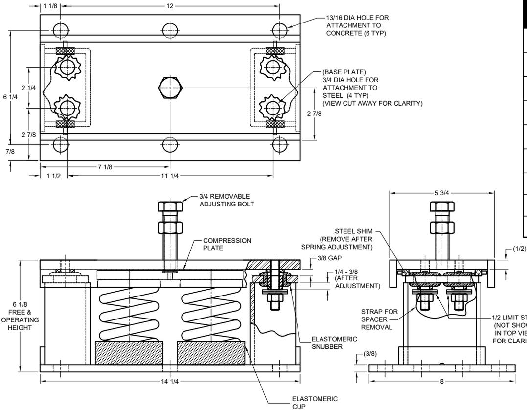
**MODEL M2SSH-1E SEISMICALLY RESTRAINED VIBRATION ISOLATOR FOR 1" DEFLECTION**
